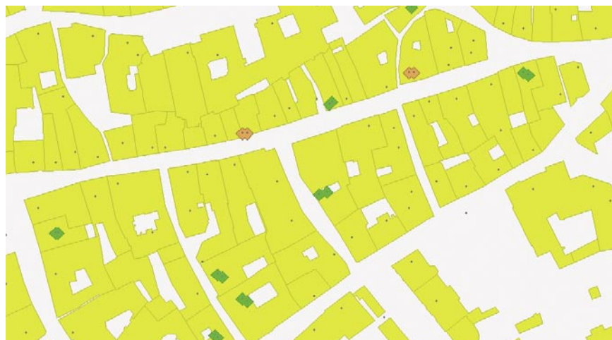
Grafische Auswertung der Redundanzprüfung bei Adresskoordinaten: Auffälligkeiten werden entsprechend der Fehlerwahrscheinlichkeit farblich markiert
